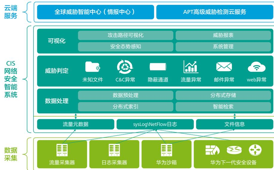
图1. 分布式方案架构
